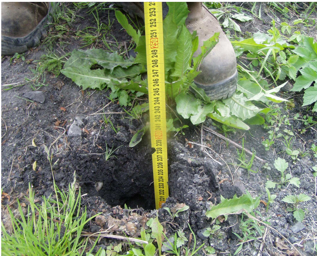
Odwiert nr 3 str. P, km 0+500 Odwiert do głębokości 2,50m p.p.t.
