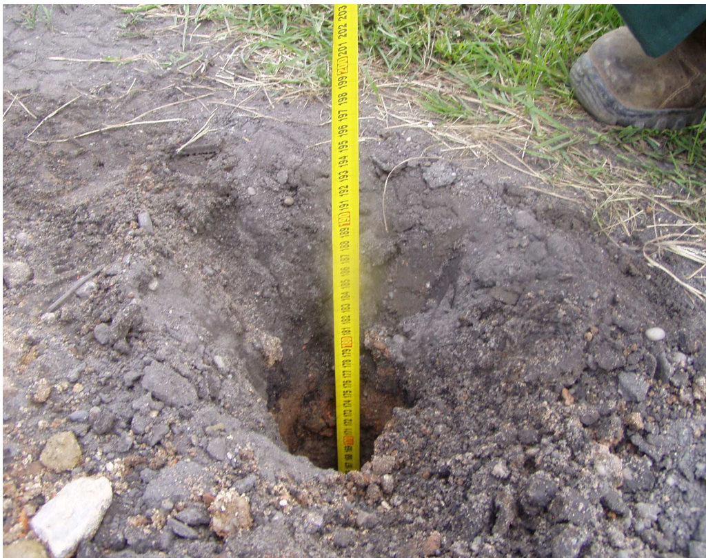
Wykonywanie odwiertów w istniejącej nawierzchni drogi Odwiert do głębokości 2,5m p.p.t. (na 1,6m woda)
