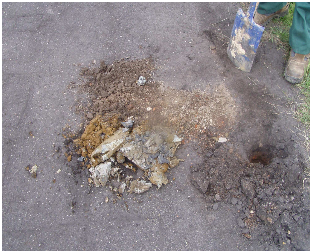
Wykonywanie odwiertów w istniejącej nawierzchni drogi Grunt (20cm H//szlaka/gruz + 50cm H//Pr + 70cm Pog + 110cm G mokra)
