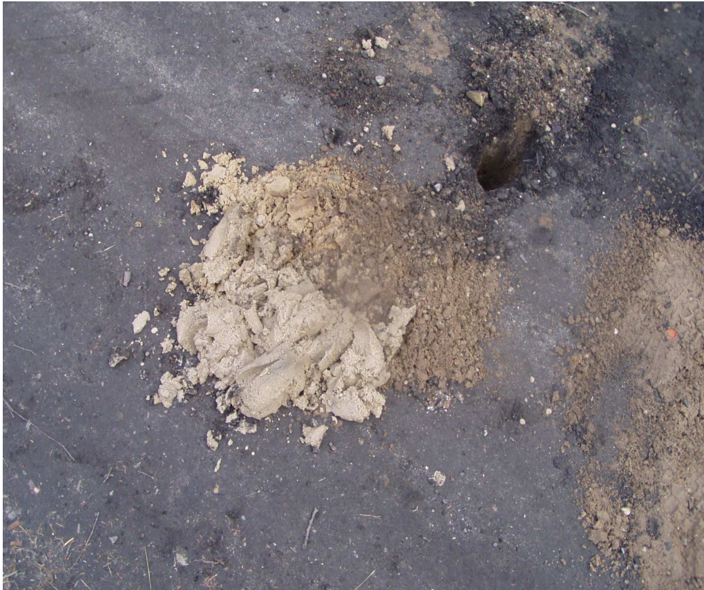
Wykonywanie odwiertów w istniejącej nawierzchni drogi Grunt (10cm H/szlaka + 60cm Pr + 50cm Pd barwy białej mokry)
