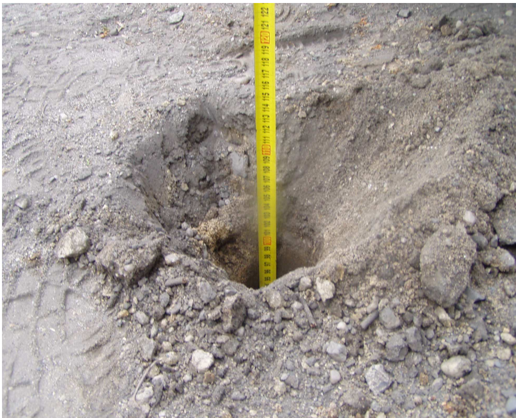
Wykonywanie odwiertów w istniejącej nawierzchni drogi Odwiert do głębokości 2,50m p.p.t.
