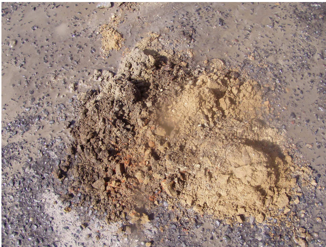
Odwiert nr 2 ul. Wojska Polskiego nasyp budowlany, piasek
